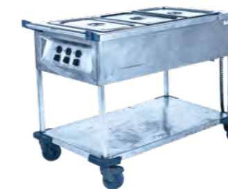
395 Bain-marie électrique 220 V / 16A monophasé - 2,5 kW. Temps de chauffe à sec : 30 min. Commande indépendante des compartiments. Thermostat réglable de 30°C à 95°C. Livré avec 3 bacs gn 1/1. Ext. : L 122 ; l 70 ; H 90 cm. 55 Kg
